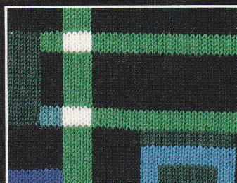
die eingebaute Intarsienschaltung für großflächige Muster (Bildmotive)
