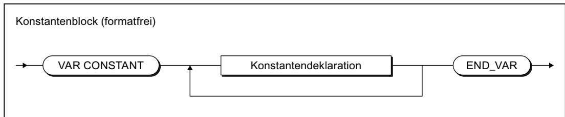
Bild 4-18 Syntax: Konstantenblock in einer POE
