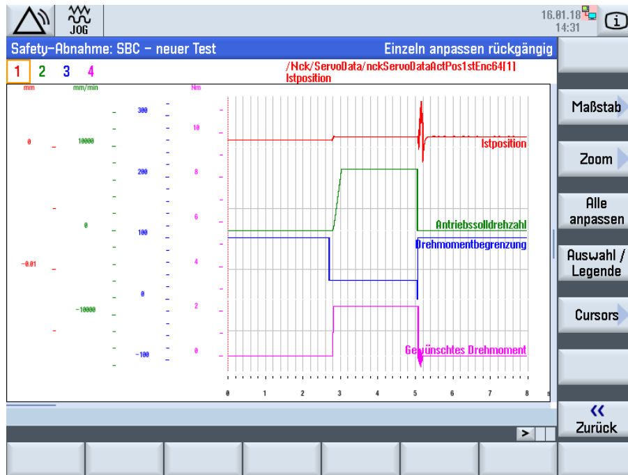
Bild 8-39 Abnahmetest - Bremsentest Trace
