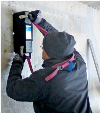
Bild 1: Einsatz und Messprinzip eines multistatischen Ultraschallarrays; beschleunigte Messdatenaufnahme durch Mehrfachanordnung von Sendern und Empfängern
