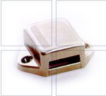
Schlossgehäuse aus ABS-Kunststoff 10-15 \mu\text{m} verkupfert, 5-10 \mu\text{m} velours vernickelt
