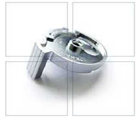
Schaltscheibe aus PA für Elektrogeräte. PA-Kunststoff mit 30% GF 20-25 \mu\text{m} verkupfert, matt vernickelt und verchromt
