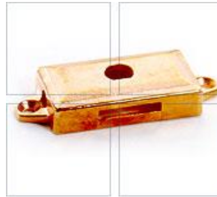
Schlossgehäuse aus Zinkdruckguss verkupfert 5-10 \mu\text{m} glanz und vernickelt 3-5 \mu\text{m}
