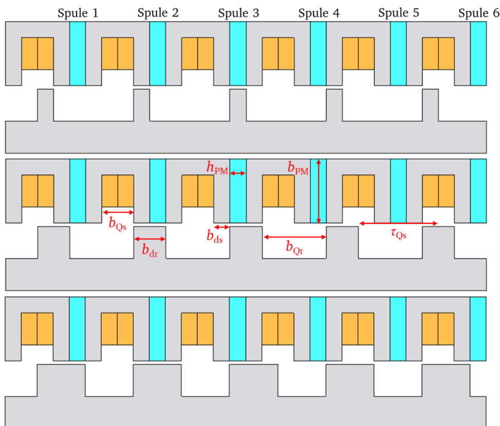
Abbildung 3.12: Vereinfachte, geometrisch lineare Anordnungen einer FSM mit sechs Statorzähnen ( h_{PM} = 10 \text{ mm} , b_{PM} = 40 \text{ mm} , b_{Qs} = 20 \text{ mm} , b_{ds} = 10 \text{ mm} ) und fünf Rotorzähnen zur Untersuchung verschiedener Rotorzahnbreiten b_{dr} (oben: 10 \text{ mm} , mittig: 20 \text{ mm} , unten: 30 \text{ mm} ) in JMAG ( B_R = 1,2 \text{ T} , \mu_{r,Fe} = 10000 = \text{konstant} , \mu_{r,m} \approx 1 )
