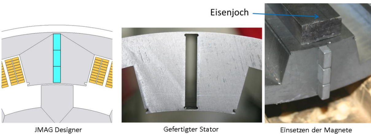
Abbildung 6.1: Statorzahn der finalen Auslegung der FSM (links: JMAG 2D-Zeichnung, mittig: Blechpaket ohne Magnete, rechts: eingesetzte Magnetreihe)
