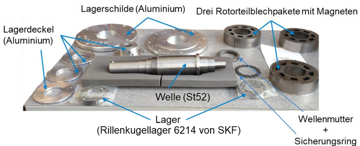
Abbildung 6.9: Rotorteile des Prototypmotors PMSM_VM mit vergrabenen Magneten
