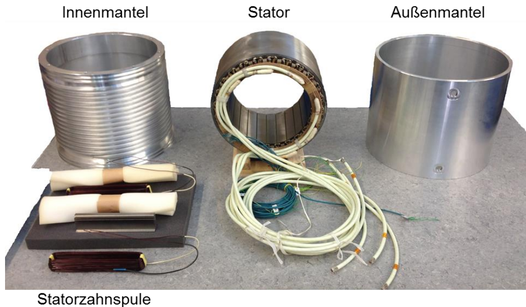
Abbildung 6.7: Statorteile des Prototypmotors mit vergrabenen Magneten im Rotor
