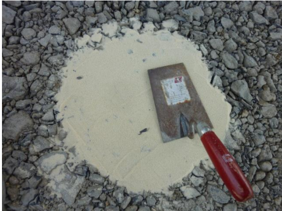
Prüfstelle vorbereiten (mit Ausgleichsschicht)
