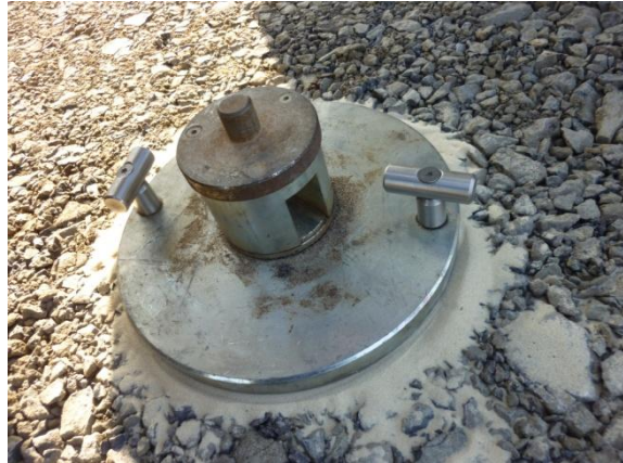
Prüfplatte satt aufsetzen
