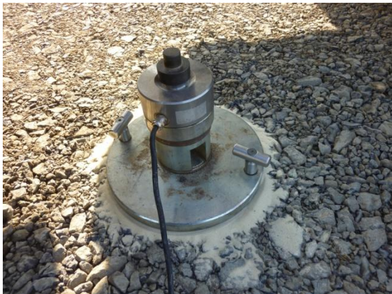
Kraftmessdose auf die Platte aufsetzen.
