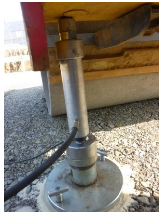
Hydraulikzylinder aufsetzen und Platte andrücken
