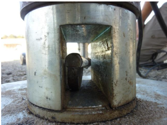
Tastarm mittig auf der Lastplatte positionieren
