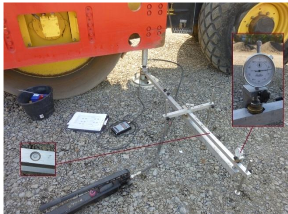
Messbrücke aufstellen und ausrichten
