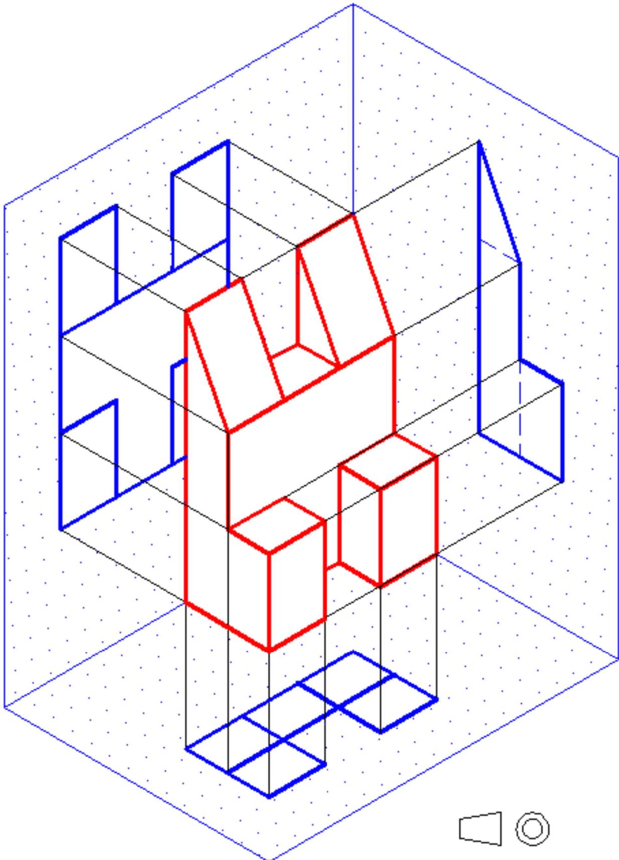
Der Kegel ist das Sinnbild für die Projektionsmethode 1, die im Maschinenbau in fast ganz Europa üblich ist, und bedeutet, dass die linke Seitenansicht rechts neben der Vorderansicht angeordnet wird. Dieselbe Ansicht wird links angeordnet bei der Projektionsmethode 3, die z.B. in USA und im Stahlbau gilt.
