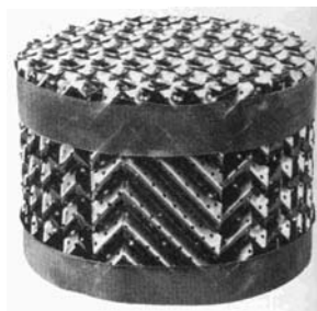
Abb. 15: Füllkörper sowie eine strukturierte Packung und Aufbau einer Packungskolonne
