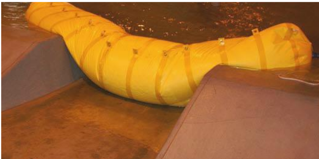
Abbildung 30: Versuch Deichbruchschließung mittels PLUG [Resio et al. 2011]
