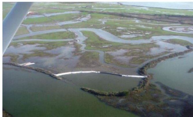
Abbildung 43: AquaDam®-Notfallverschluss bei dem Deichbruch bei Humboldt Bay
