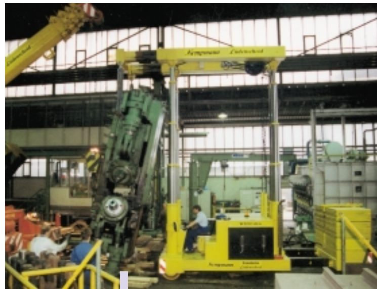
Riggers TriLifter mit 65 Tonnen Hubkraft von Kempmann.
