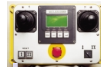
Die Bedieneinheit mit elektronischer Anzeige von Höhe, Fahrweg und Seitenvorschub entwickelt von Krah.
