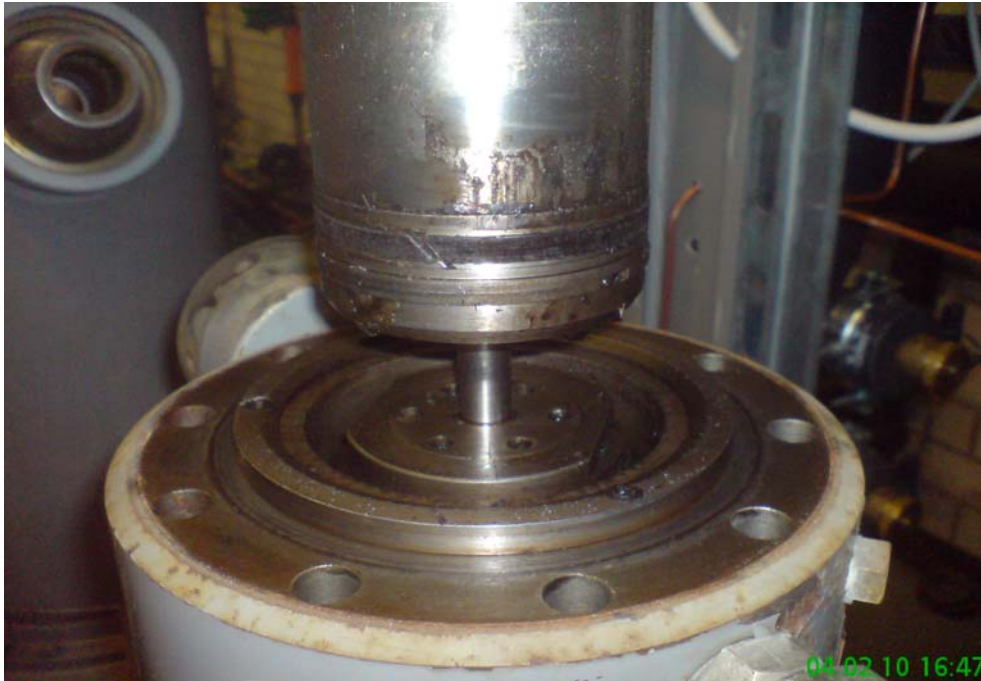
Abbildung 5–10: Verdrängerkolben im Ausgangszustand
