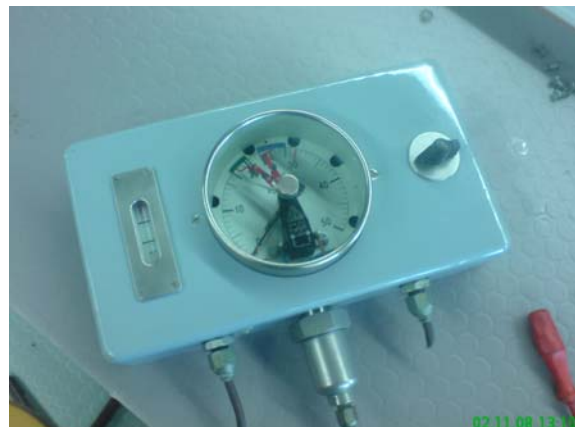
Abbildung 5-3: Das Kontaktmanometer nach der Restauration
