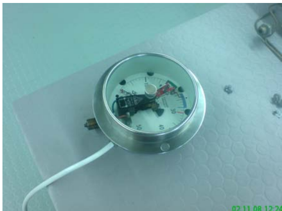
Abbildung 5-3: Das Kontaktmanometer nach der Restauration
