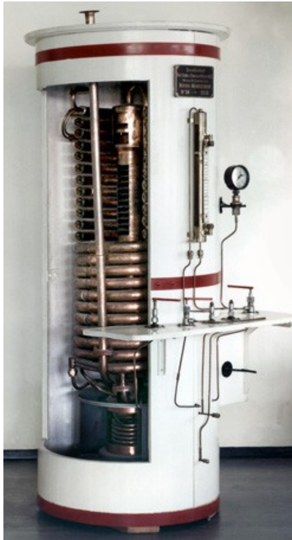
Abbildung 1–3: Weltweit erste Luftzerlegungssäule zur Sauerstoffgewinnung
