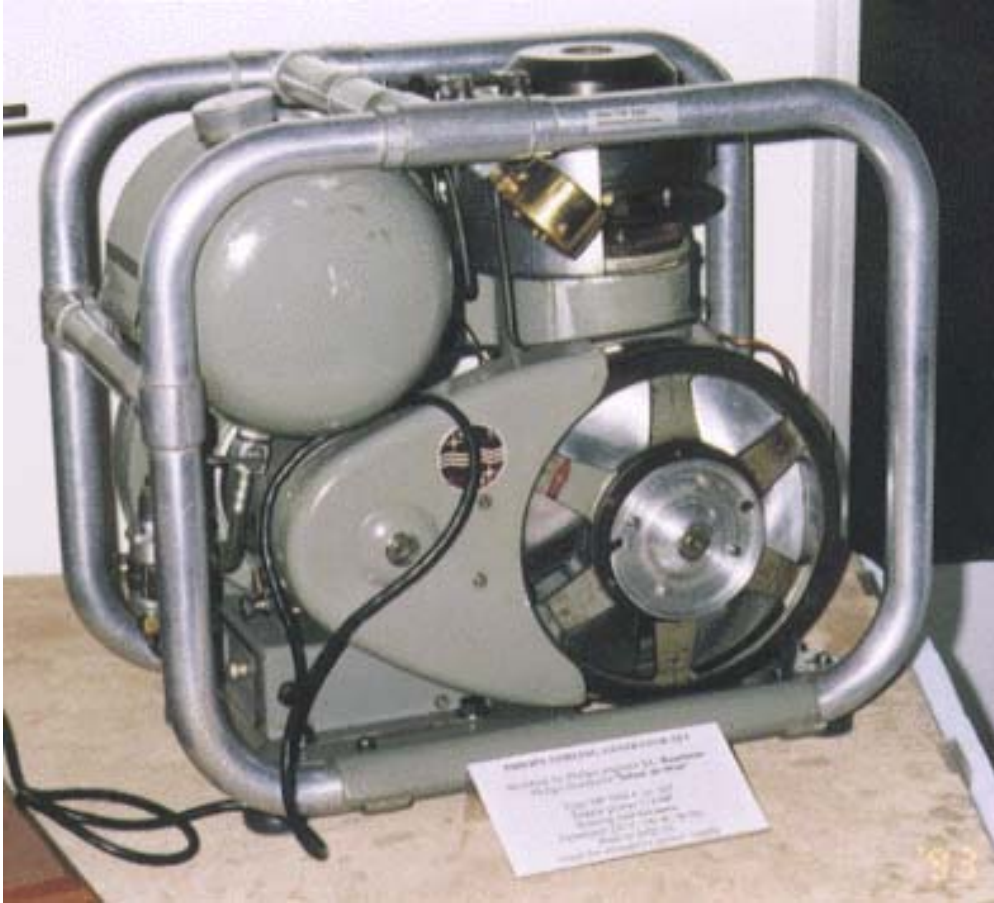
Abbildung 1–7: Stromaggregat für Rundfunkempfänger (Fa. Philips)
