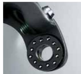
La arandela de pivote revestida y el cojinete de empuje de los pivotes reducen la carga en el puente de freno. (DURA-ACE)
