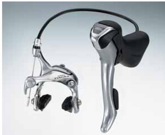
El sistema SLR logra la reducción de fricción en el puente de freno, la palanca y el cable.
