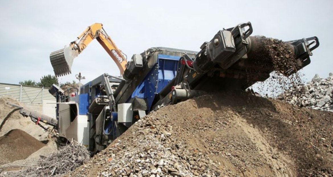
Moderne Brecher- anlage für Bauschutt
