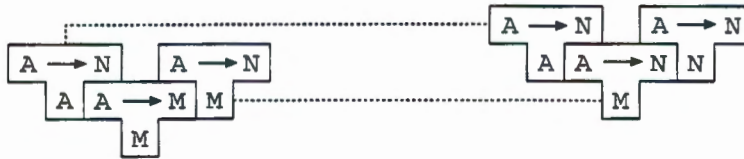
Abbildung 1.6: Selbst-Übersetzung eines Compilers
