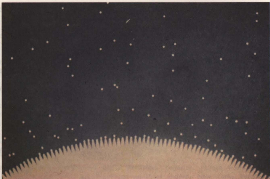
Abb. 2b: Tröpfchenabgang an der Rotations-scheibe des Gerätes (Aufnahme Fa. Mantis, Hamburg)
