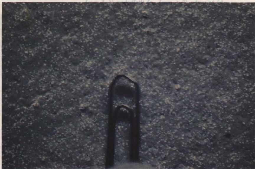
Abb. 3: Gleichmäßige Tröpfchenverteilung nach dem Einsatz des ROFA-CDA-RLV-Gerätes (Aufnahme Fa. Mantis, Hamburg)
