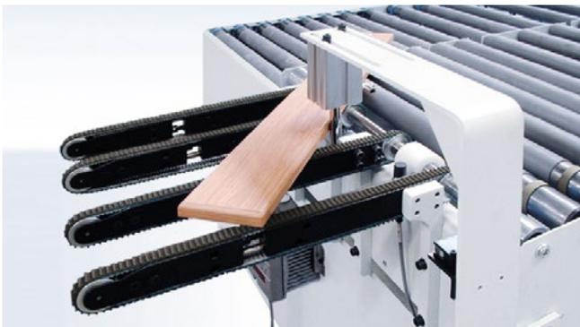
**Drehbolzen für Schmalteile**
