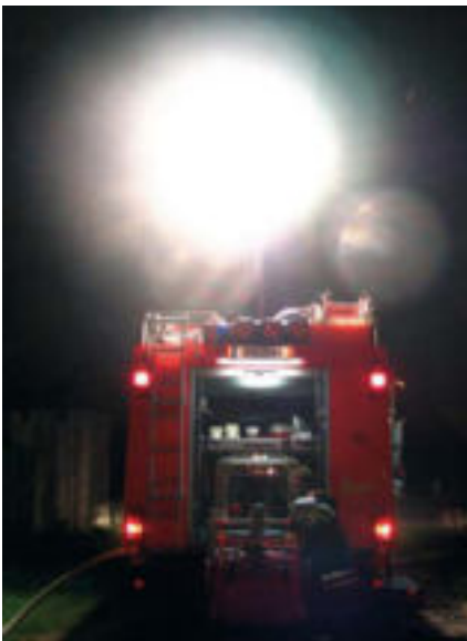
Blendung durch die starke Lichtquelle des Lichtmastes innerhalb des Sehfeldes
