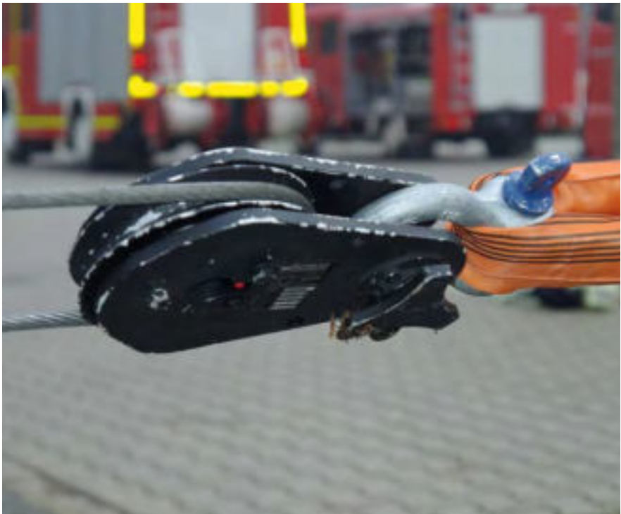
Einsatz einer losen Rolle
