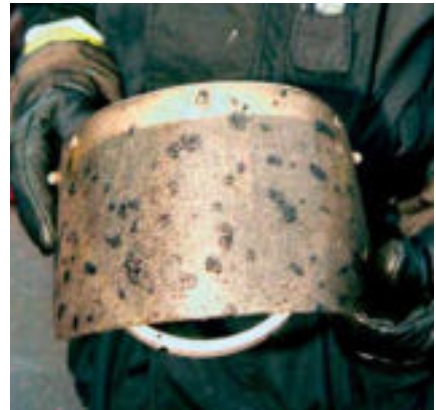
Gesichtsschutz nach starker Wärme-Einwirkung
