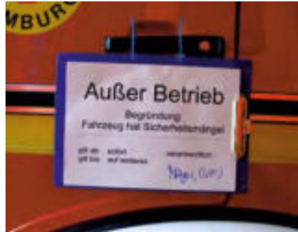
Bei Mängeln, die die Betriebsicherheit gefährden, dürfen Fahrzeuge nicht mehr betrieben werden.
