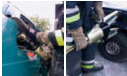
Einsatz eines Schneidgerätes Einsatz eines Spreizers
