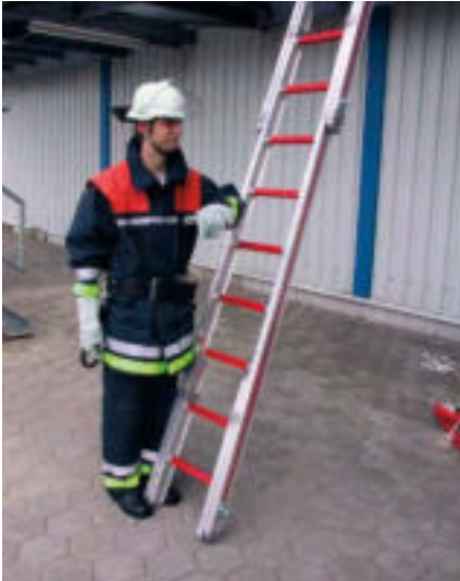
So kann der richtige Anstellwinkel überprüft werden.
