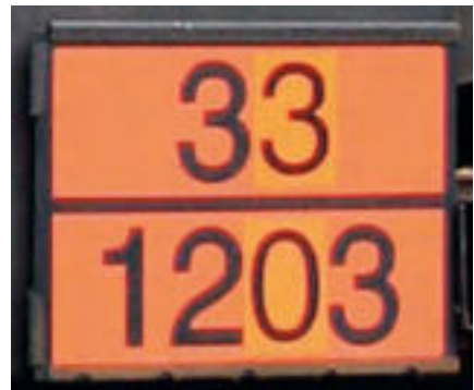
Gefahrnummer (oben) und Stoffnummer (UN-Nummer, unten)
