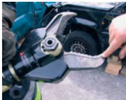
Sichtprüfung der Schneidmesser
