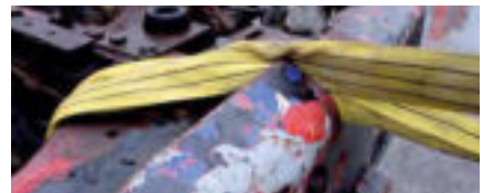
Vorsicht! Hebebänder nicht über scharfe Kanten spannen.
