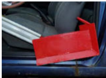
Einsatz eines Rettungszyinders mit Schweller-aufsatz.
