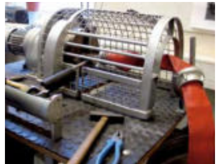
... mit wirksamer Schutzvorrichtung gegen sich lösende Teile
