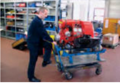
Transportwagen für Tragkraftspritzen mit mechanischer Höhenverstellung
