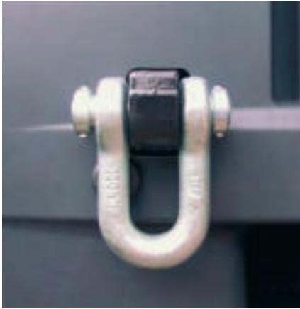
Festpunkt am Feuerwehfahrzeug (160 kN)
