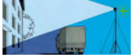
Hoch angeordnete Lichtquellen verringern die Schattenbildung.
