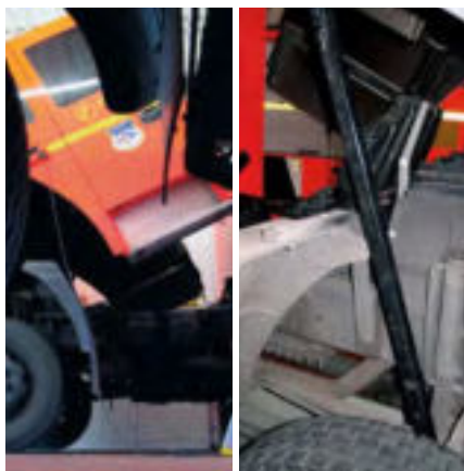
Gekipptes Führerhaus ... mit Sicherung gegen unbeabsichtigtes Absinken
