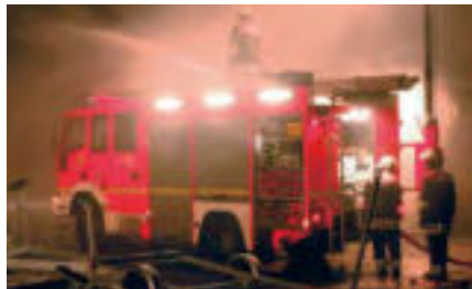
Fahrzeug-Umfeldbeleuchtung und Lichtmast am Löschfahrzeug zur Einsatzstellenbeleuchtung
