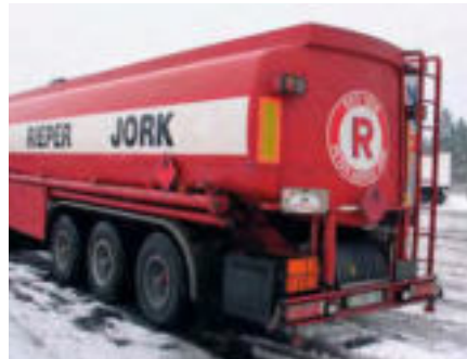
Tankfahrzeug – Warntafel mit Kennzeichnungsnummern und Gefahrzetteln
