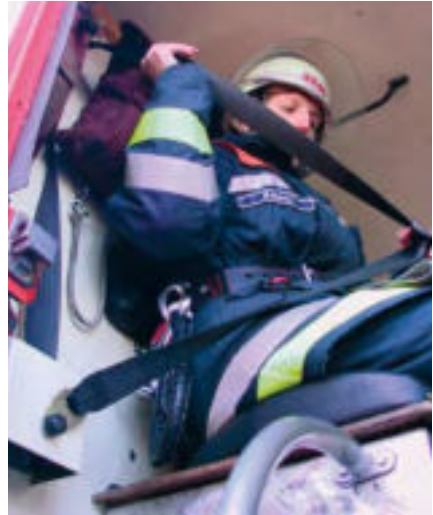
Nachgerüsteter Sicherheitsgurt mit Aufrollautomatik im Mannschaftsraum
