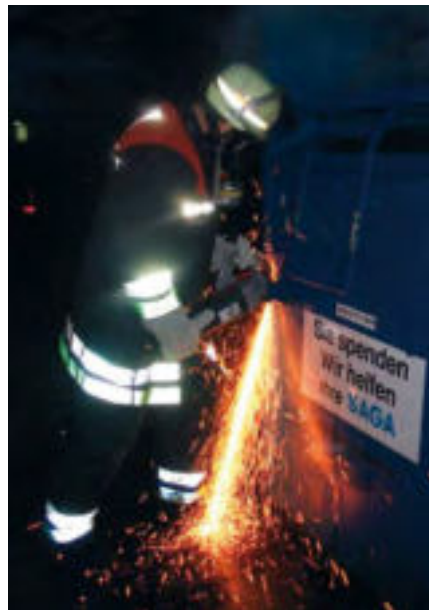
Die abgeschlossene Verriegelung eines brennenden Altkleider-Containers wird mittels „Flex“ getrennt.
