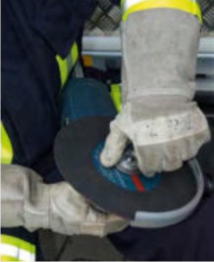
Das Aufspannen der Trennschleifscheibe muss mit Sorgfalt durchgeführt werden.
