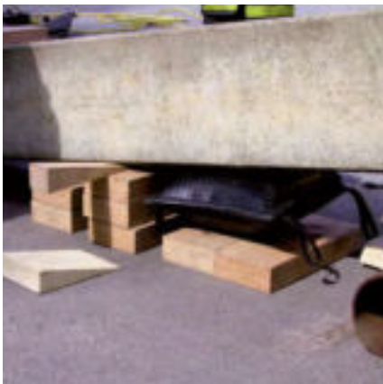
Hochdruckkissen – der Einsatz ist in engen Zwischenräumen möglich.
