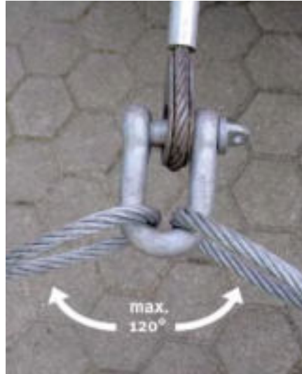
Maximum: Der Seilspreizwinkel beträgt 120 °.
