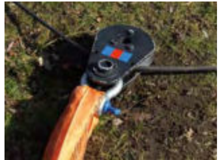
Umlenkung durch feste Rolle
