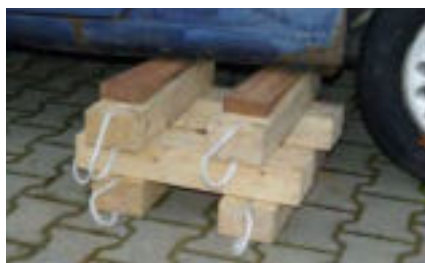
Unterbau durch Rüsthölzer
