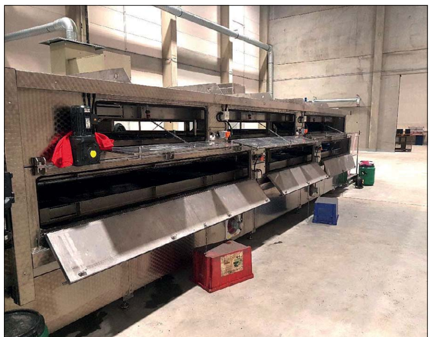
Bild 3. Automatisierte Recyclinganlage für Lithium-Ionen-Zellen. (Bild: Erlös)
