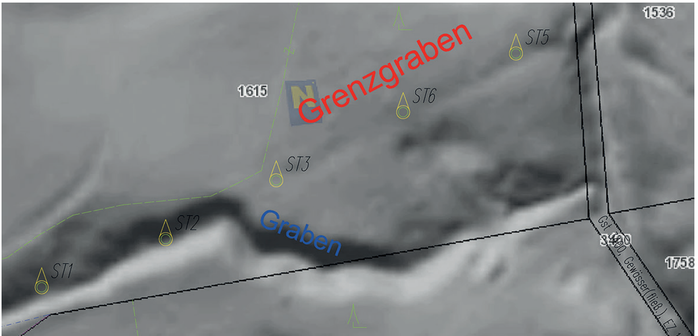
Abbildung 5: Laserscan-Geländemodell kombiniert mit Naturaufnahme und Katastralmappe
