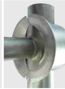
T-Stück-Spanneinsätze mit Aufnahmemöglichkeit des ausgehalsten und des anzuschweißenden Rohres
