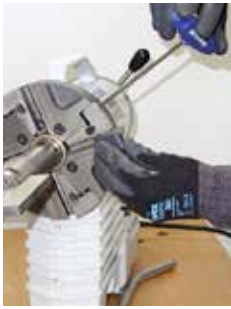
Werkzeug-Schnellspannsystem QTC® (Quick-Tool-Change)
