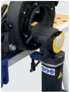
Inklusive zweite Sägeblattaufnahme zum Herausstrennen von Rohrbögen
