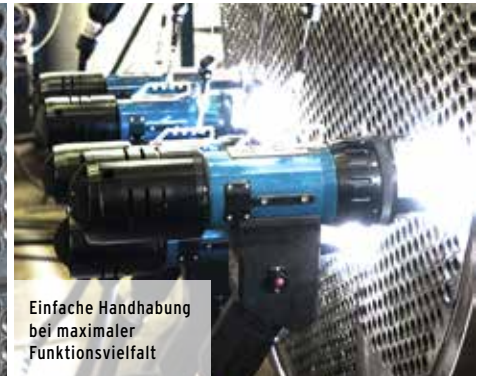
Flüssigkeitsgekühlter Brennerkopf bis 30° stufenlos schwenkbar
