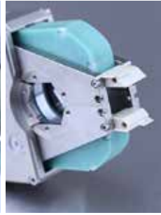
Aufklappbare Schweißkopfabdeckung "FlipCover"
