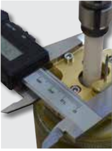
Einfache und präzise Einstellung der Elektrodenposition
