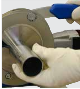
Schnellwechselsystem für Werkzeuge, Spannschalen und Rohre
