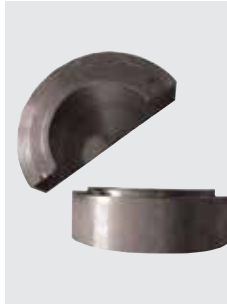
Kammereinsätze für Formteile zum Schweißen von Formstücken
