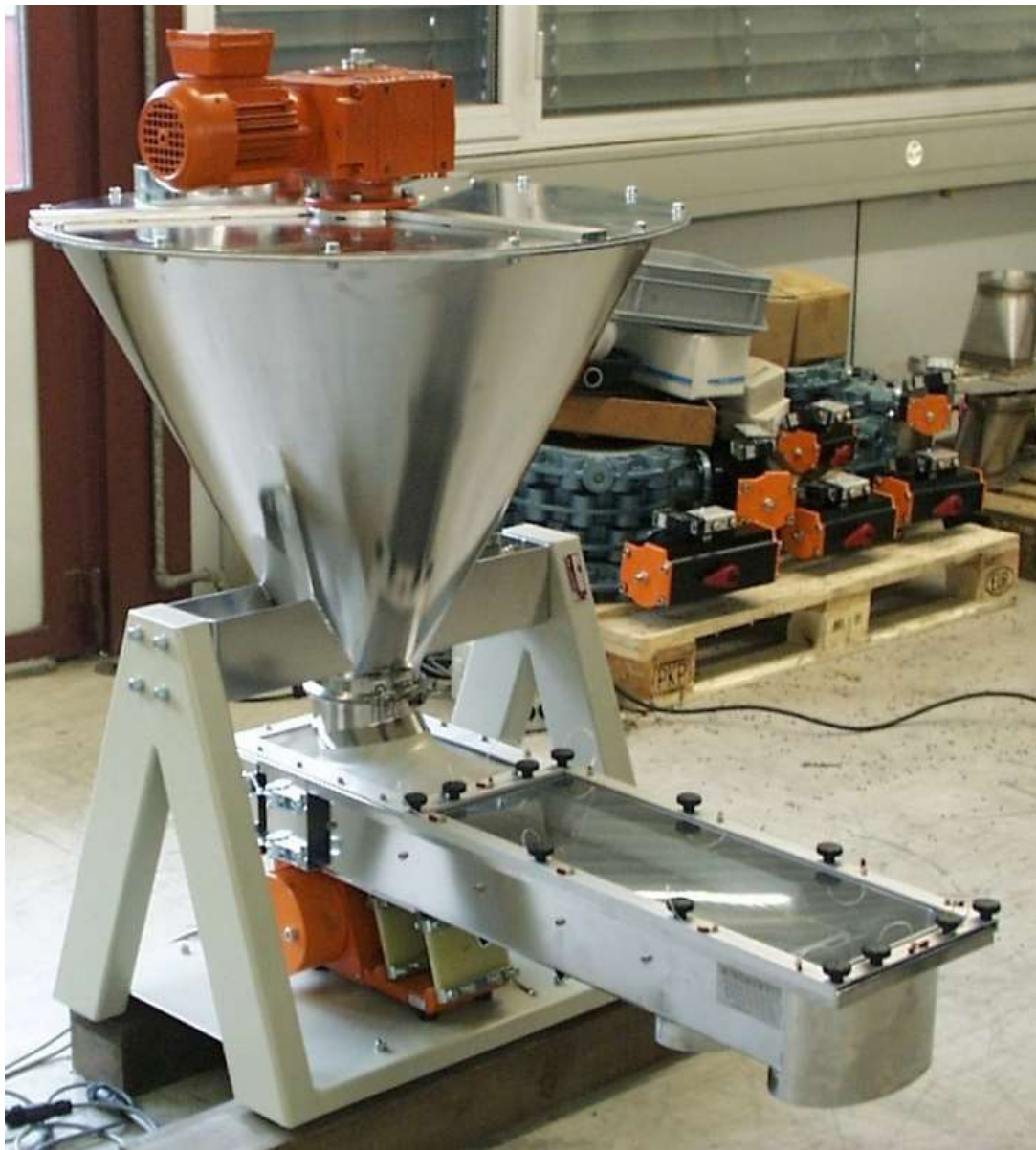
Siebrinne mit Überkorn-Abwurf. Vorlagebehälter mit Vertikalrührwerk.
