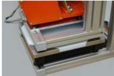
Wägeplattform mit Single-Point Messwerverfassung Resonanz-Frequenz-Antrieb
