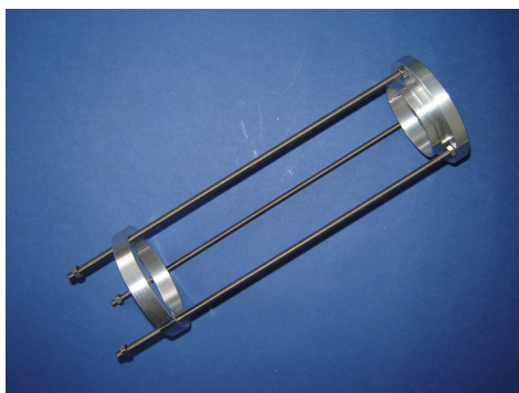
Abbildung 2.2: Aluminium-Halterungssystem zur mechanischen Ankopplung der 50cm × 4cm × 3cm Szintillatoren an die Photoröhre.
