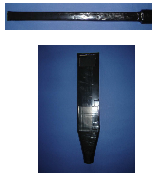
Abbildung 5.2: 3\text{ cm} \times 4\text{ cm} \times 50\text{ cm} und 9.5\text{ cm} \times 4\text{ cm} \times 30\text{ cm} Szintillator, wie sie für das Hodoskop verwendet wurden
