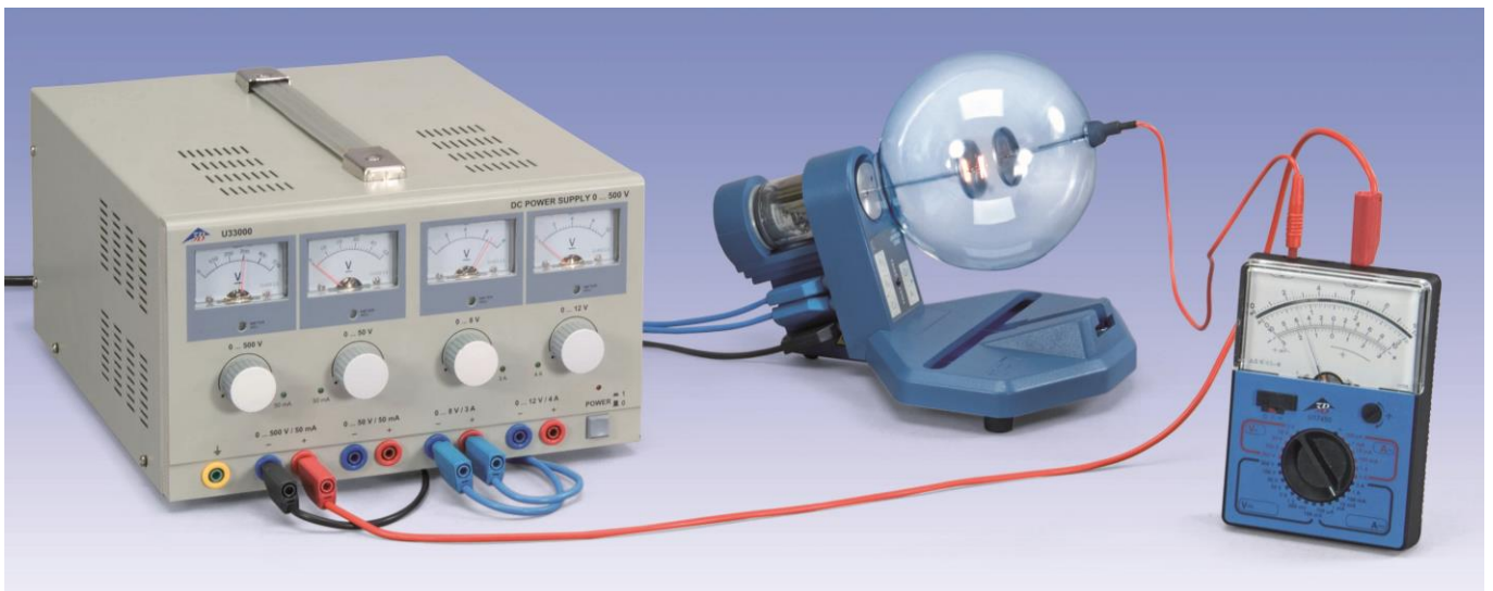
Fig. 1: Schaltung (oben) und experimenteller Aufbau (unten) zur Aufnahme der Kennlinien einer Röhrendiode für verschiedene Kathoden-Heizspannungen. (1) Kathode, (2) Anode
