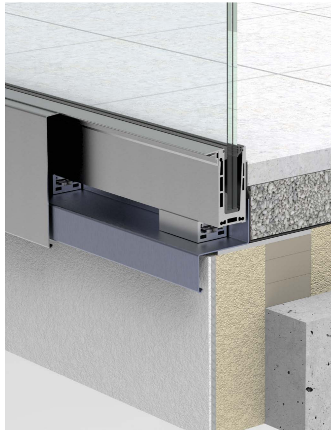
AUFGESETZTE BODENMONTAGE MIT NOTENTWÄSSERUNG UND NICHT SICHTBAREM GLASHALTEPROFIL.
