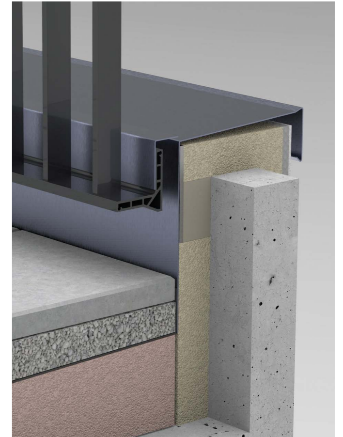
SEITENBEFESTIGUNG FÜR SCHMALE ATTIKAAUSBILDUNG. NICHT SICHTBARE VERSCHRAUBUNG.
