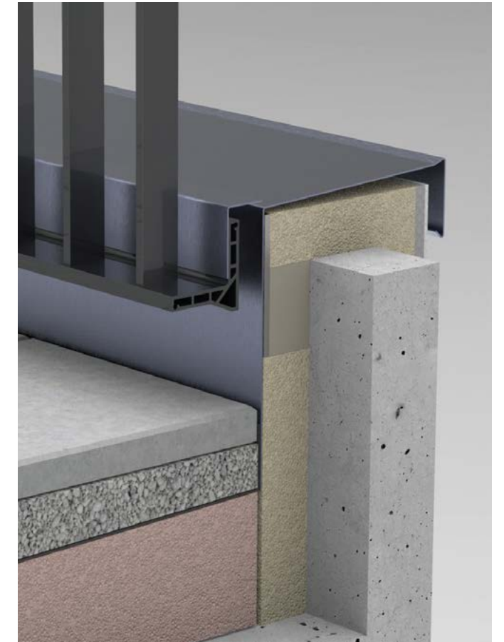
SEITENBEFESTIGUNG FÜR SCHMALE ATTIKAAUSBILDUNG. NICHT SICHTBARE VERSCHRAUBUNG.
