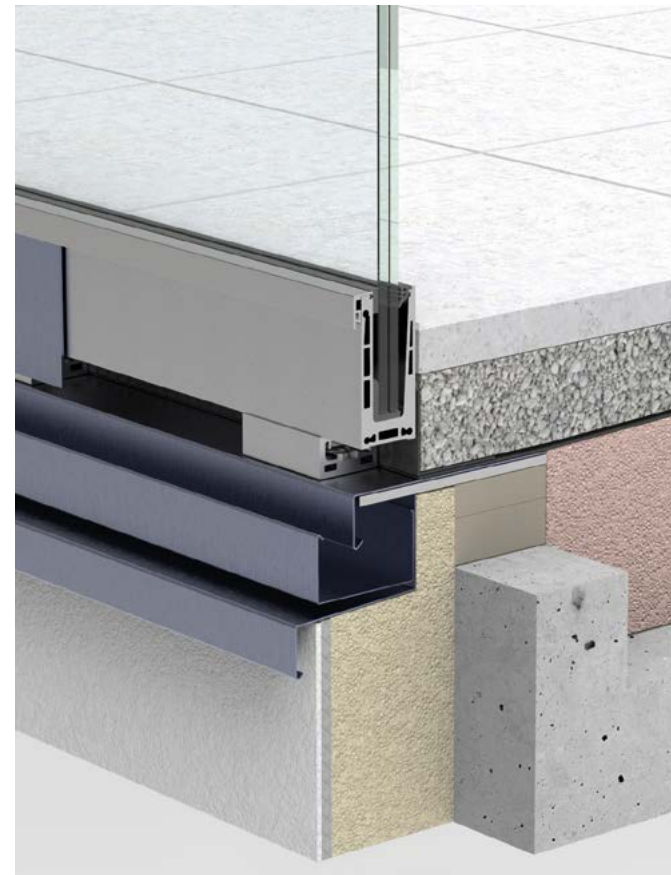
BODENBEFESTIGUNG ANGEPASST AN DEN FUSSBODENAUFBAU. MIT BLECH-VERKLEIDUNG UND REGENRINNE ZUM ABLEITEN VON REGENWASSER UND NOTENTWÄSSERUNG.
