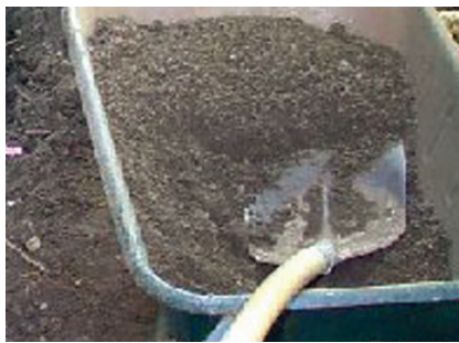
Gemischte DERNOTON®-Fertigmischung BA mit DERNOTON®-Pulver
