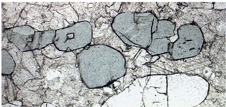
blaßgrüne Mg-Al-Spinelle neben einem Olivin (hell, am unteren Bildrand) und Calcit (z.T. mit typischer Rhomboederspaltbarkeit in einem Marmor aus dem Baikalsee-Gebiet; Hellfeld; Bildausschnitt ca. 2.6 mm quer
