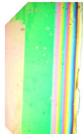
ABBILDUNG 2 Abhängigkeit des Gangunterschieds von der Dicke am Beispiel eines Gipskeils vom intensiven Rot der 1. Ordnung rechts (ca. 10 \mu\text{m} dick) zum verwachsenen Rot der 4. Ordnung links (ca. 40 \mu\text{m} )
