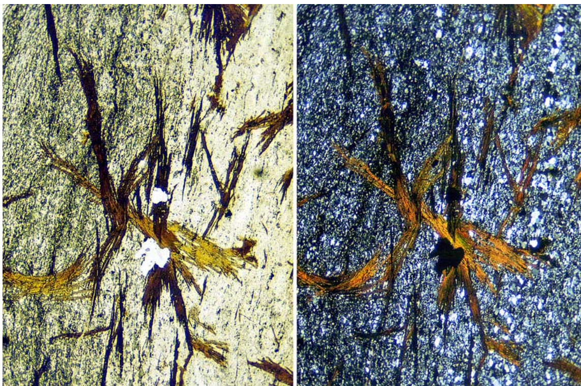
garbenförmige Aggregate von Stilpnomelan in einem grünschieferfaziellen Metabasalt aus dem Münchberger Gneisgebiet, links im Hellfeld, rechts unter gekreuzten Polarisatoren; Bildausschnitt ca. 7.2 mm hoch; die feinkörnige Grundmasse besteht überwiegend aus albitreichem Plagioklas, daneben aus Epidot und Quarz.
