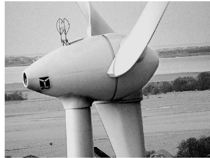
Beispiel für eine spezielle Blattform im Wurzelbereich, Enercon E-70 E4
