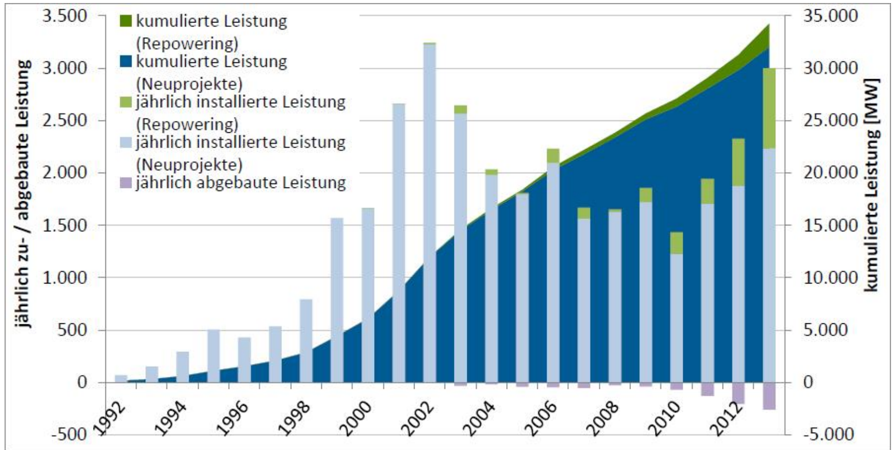
Abbildung 1: Entwicklung der jährlich installierten und kumulierten Leistung [MW] aus Windenergie an Land in Deutschland, Status 31.12.2013
