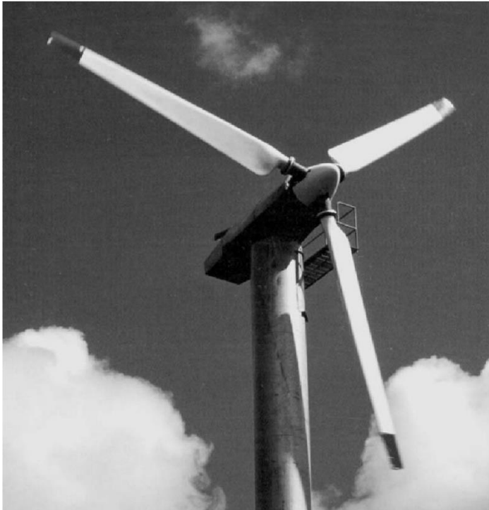
Typische dänische WKA mit 3-Blattrotor ohne Einstellwinkelverstellung
