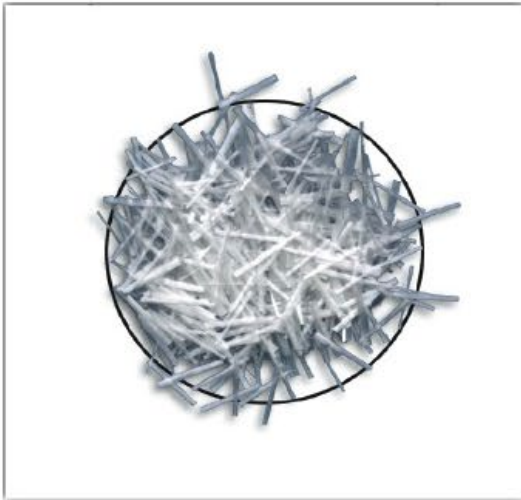
Glasfasern zur Schwindriss- Reduzierung
