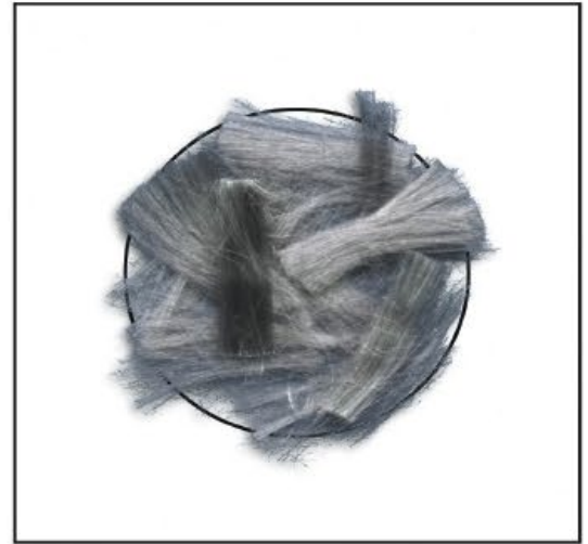
Multifilamentale PP-Fasern zur Schwindriss-Reduzierung
