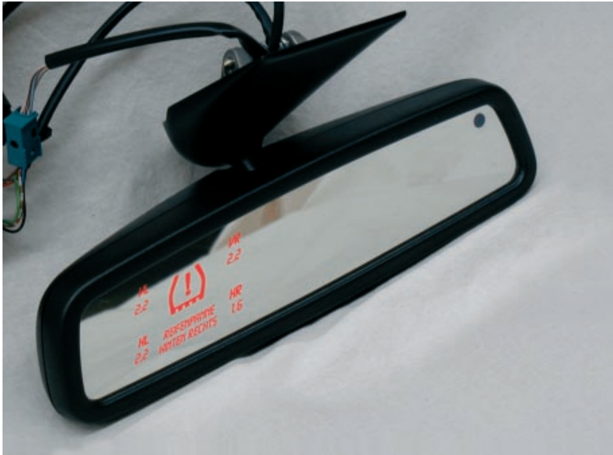
Bild 3: Das RDKS schafft eine Kommunikationsplattform zu On-Bord-Fahrzeugsystemen und intelligenten externen Systemen.
