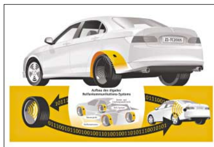
Bild 1: Das batterielose, bidirektional arbeitende Tyrecom System nutzt den 2,4 GHz Bereich und ist daher ohne Umrüstung weltweit einsetzbar.
