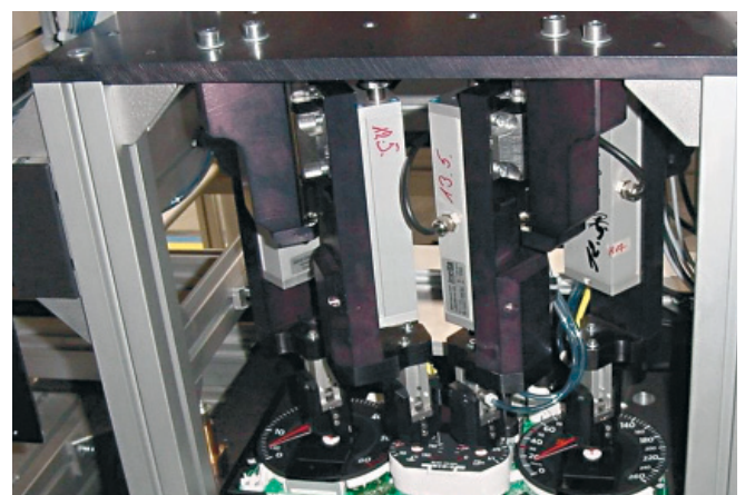
Üben schnell Druck aus: Bei einem Automobil-Zulieferer pressen vier lineare Stellantriebe mit 2,5 mm/s die Zeiger auf die Stahlachsen der Instrumentenpanels.
