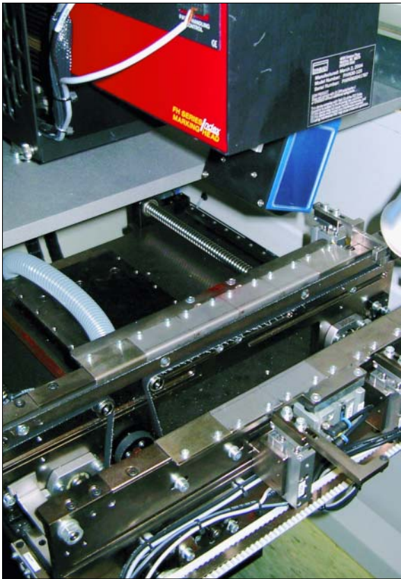
Bild 4: Laser-Kreuztisch für's Markieren
