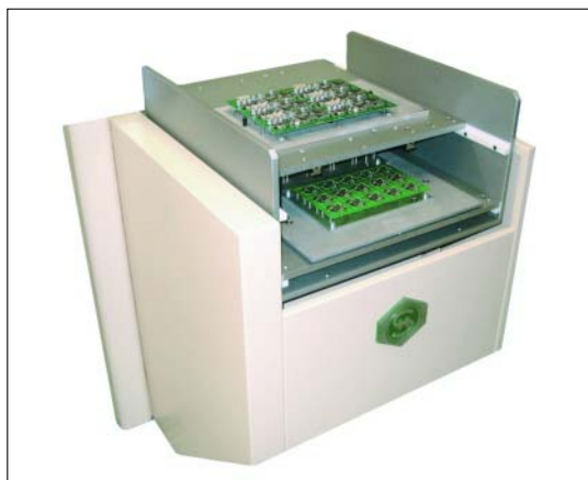
Bild 2: Zwei-Ebenen-Beladung schafft höheren Durchsatz
