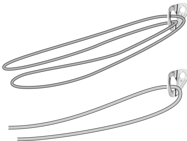
Abb. 19: einfache Methoden des Seilzugquergangs
