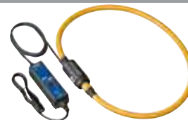
FLEXIBLER STROMSENSOR 9667(CT) 500A AC/ 5000A AC (wählbar), φ254mm, Stromversorgung: LR06 alkalische Batterien oder AC-NETZTEIL 9445-03 (bei Bestellung angeben)
