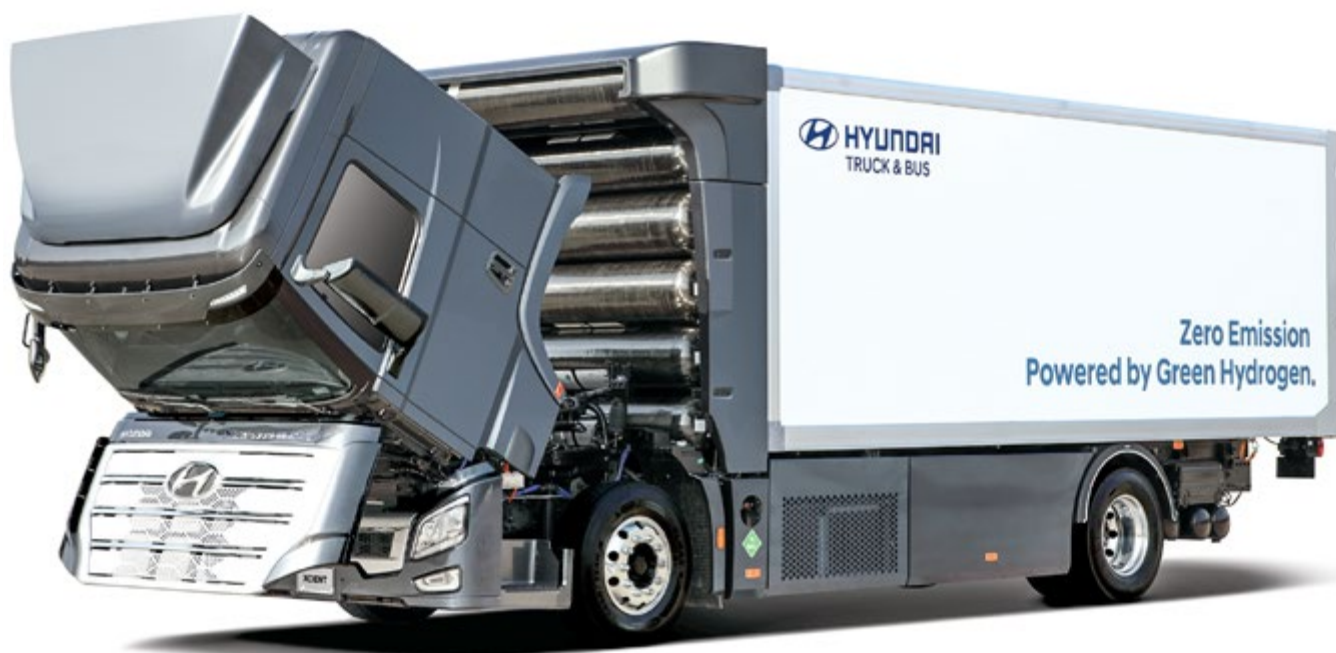
Die Wasserstofftanks dieses Lastwagens befinden sich hinter der Fahrerkabine.
