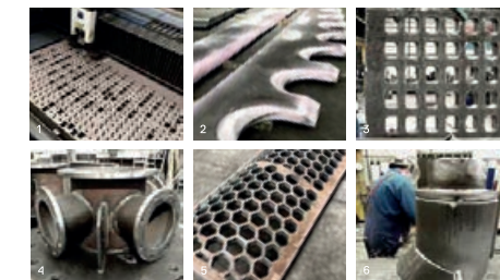
1. Laserschnitt mit hoher Toleranzgenauigkeit. 2. Messer mit anschl. Farbdringprüfung. 3. Sondersieb für einen Brecher im Steinbruch (t = 145mm). 4. Materialverteiler aus hochwertigen Abrabute - Röhren. 5. Sieb für die Recyclingindustrie. 6. Brennerbauteil für ein Braunkohlekraftwerk.
