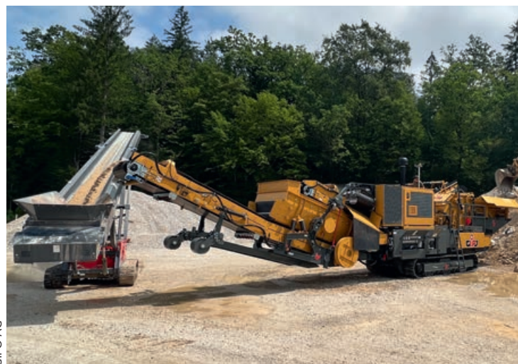
Raupenmobiler Prallbrecher in Kombination mit Haldenband Tracked impact crusher combined with stockpile conveyor
