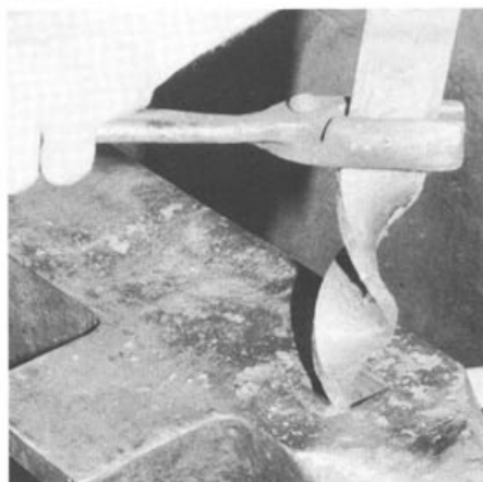
Abb. 16 Beim Verdrehen muss ein Ende des Stabes im Amboss oder Schraubstock fixiert werden. Das andere Ende wird mit der Zange oder einem speziellen Dreheisen so lange gedreht, bis die gewünschte Form erreicht ist.
