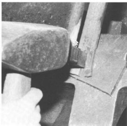
Abb. 11 Zum Spalten braucht es Schmied und Zuschläger. Der Schmied hält Stab und Schrote, die vom Zuschläger durch das Eisen getrieben wird. Damit das Werkzeug beim Austritt auf der Unterseite auf der harten Ambossbahn nicht stumpf wird, muss eine weichere Eisenplatte unterlegt werden.
