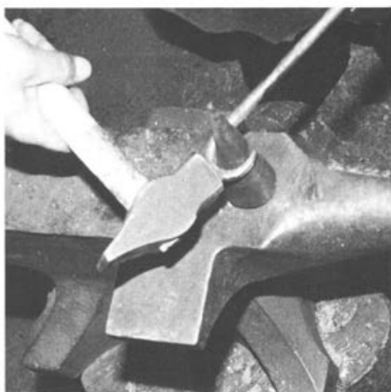
Abb. 10 Ringe und Oesen werden zunächst etwas ausgestreckt, zugleich rund geschmiedet und anschliessend am runden Horn oder wie hier an einem eingesteckten konischen Hörnchen zum Ring gebogen.
