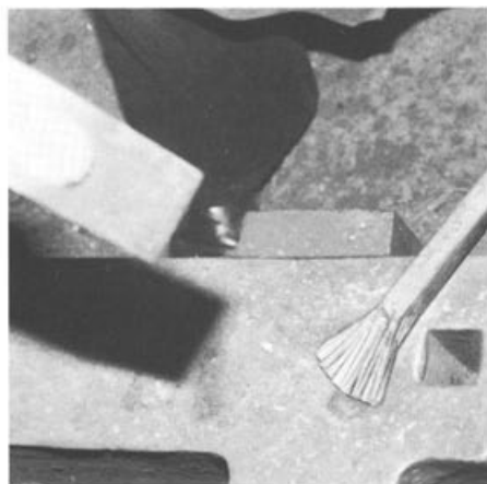
Abb. 6 Zum Breiten benützt der Schmied die schmale Hammerfinne, die ein rasches Ausbreiten bewirkt.
