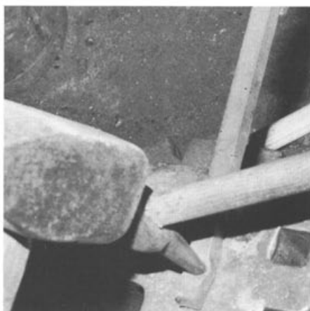
Abb. 12 Ähnlich wie beim Spalten ist der Arbeitsvorgang beim Lochen. Ist der (in diesem Falle stumpfe) Dorn nur noch wenig von der Unterseite entfernt, verlegt der Schmied die Arbeitsstelle über das Ambossloch, damit der Dorn frei durchschlagen kann.
