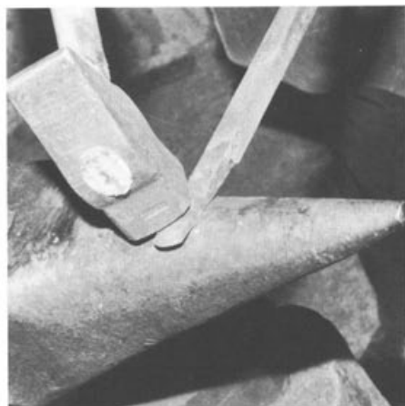
Abb. 4 Auf dem runden Ambosshorn ist der glühende Eisenstab zum Strecken aufgelegt. Durch die Wucht eines jeden Hammer-schlages wird er etwas länger.
