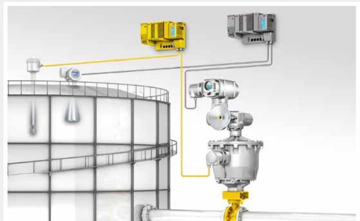
Um eine fundierte und nachvollziehbare Aussage über die Eignung von AUMA Produkten für sicherheitstechnische Anwendungen machen zu können, wurde ihre SIL-Fähigkeit ermittelt. Die Norm IEC 61508 sieht dazu zwei verschiedene Verfahren vor: die Hardwarebeurteilung und die vollständige Bewertung.
