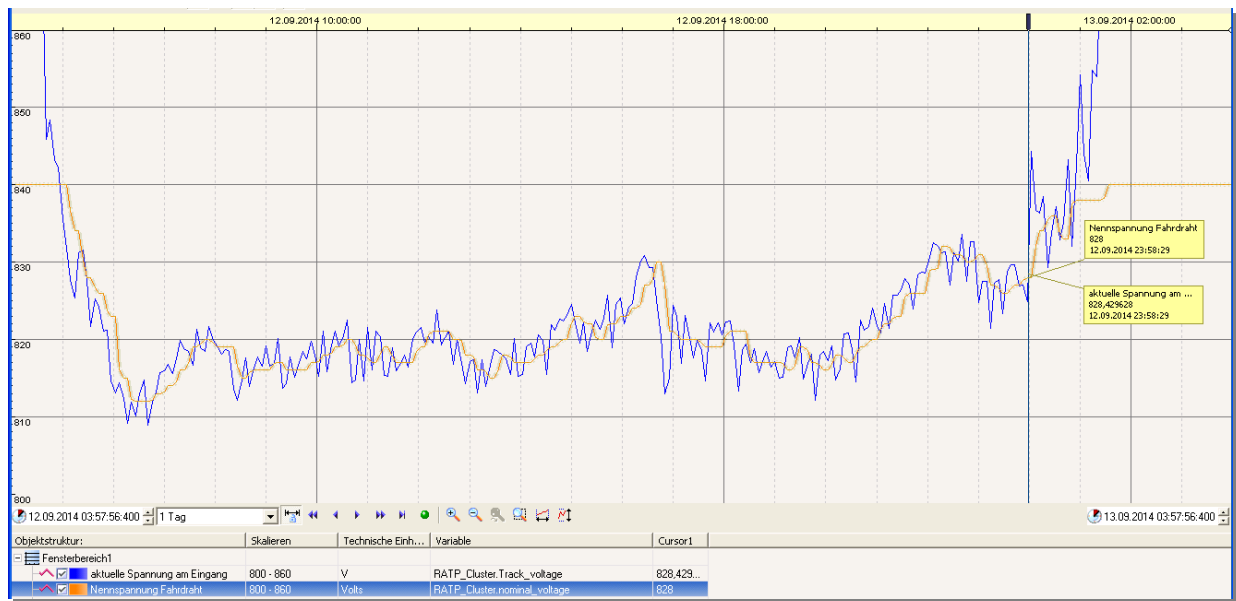
Bild 20: Aktuelle Fahrdrabtspannung und Spannungsschwelle nach der Softwareerweiterung
