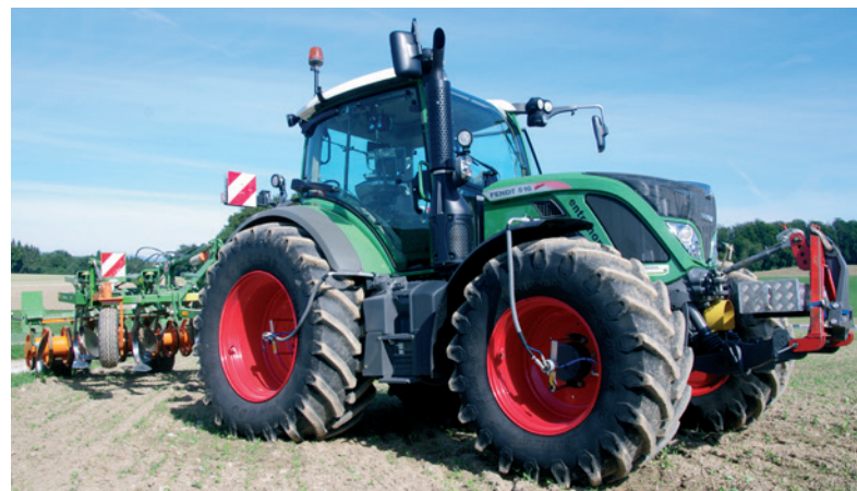
[Bild 7] Reifendruckverstellanlagen sowie Arbeitsgeräte mit eigenem Fahrwerk ermöglichen eine optimale Verteilung des eingesetzten Maschinengewichtes auf der Bodenoberfläche.
