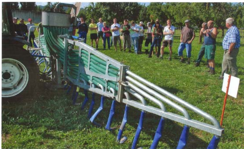
Stefan Herzog (2. von rechts), Pächter auf dem Hof Ebnet in Diegten, erläutert das System Schleppschlauch an der Verschlauchung mit Horizontalverteilkopf Wälchli; er benötigt keine Hangausgleichsvorrichtung, weil die Hangneigung 35% nicht übersteigt. (Bilder: Dominik Senn)
