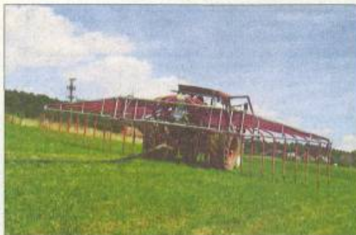
In der Schweiz ist der Schleppschlauchverteiler häufig zu sehen. Durch das streifenförmige Ablegen der Gülle entstehen weniger Verluste. (BWW Archiv)
