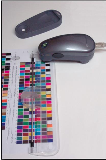
Positionierung des Eye-One Messlineals.
