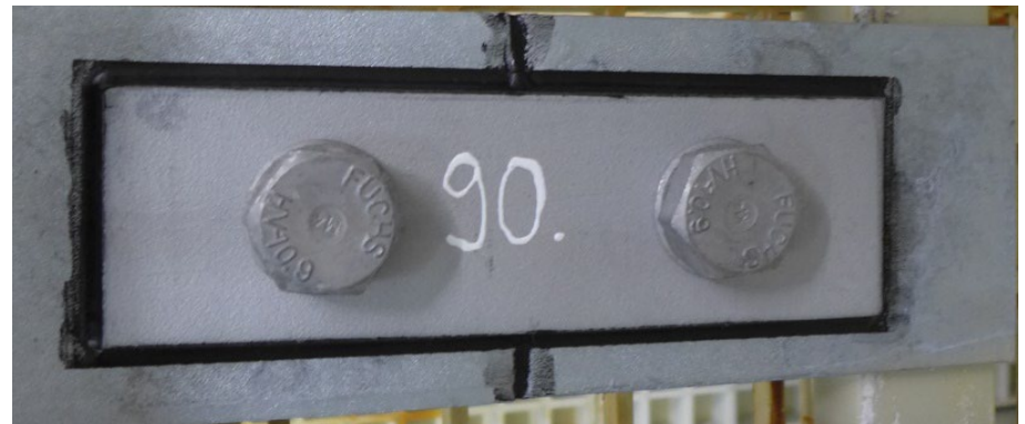
Probe für Simulation eines Laschenstoßes mit abgedichteten Fugen Quelle: IKS Dresden GmbH
