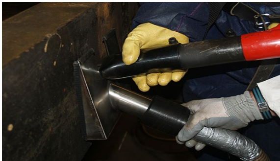
BT 36 – Nadelverfahren mit Absaugschuh
