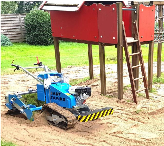
Das Modell *Baby Tapiro* ist eine mobile Sandreinigungsmaschine (auch Strandreinigungsmaschine oder Beachcleaner) zur Reinigung und Oberflächenaufbereitung von Sandstränden, Sandspielplätzen, Beachvolleyballfeldern, Golfplätzen uvm. Die Maschine fährt auf Gummiraupen, welche jegliches einsinken im Sand verhindern, wird von einem Benzinmotor angetrieben und von einem Bediener geführt.
