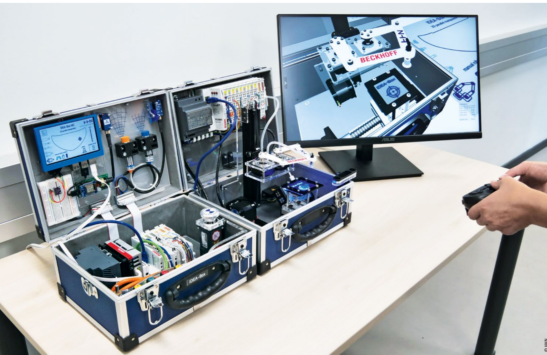
Kompakt als kleine Koffer realisiert: die IDEA-Basis-Box (links) mit dem Ultra-Kompakt-Industrie-PC C6015 und die Erweiterung um umfangreichere Motion-Funktionen (rechts) – bei denen die Bedienung per Joystick und sogar per Hand-Tracking möglich ist.
