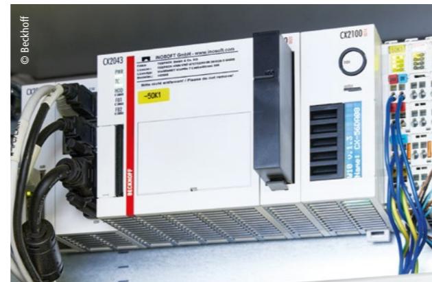
Dynamische Synchronisation sämtlicher Achsen, Safety, HMI und individuelle Datenbank-Applikation – das komplette Automatisierungsprojekt läuft auf einem einzigen Embedded-PC CX2043.
