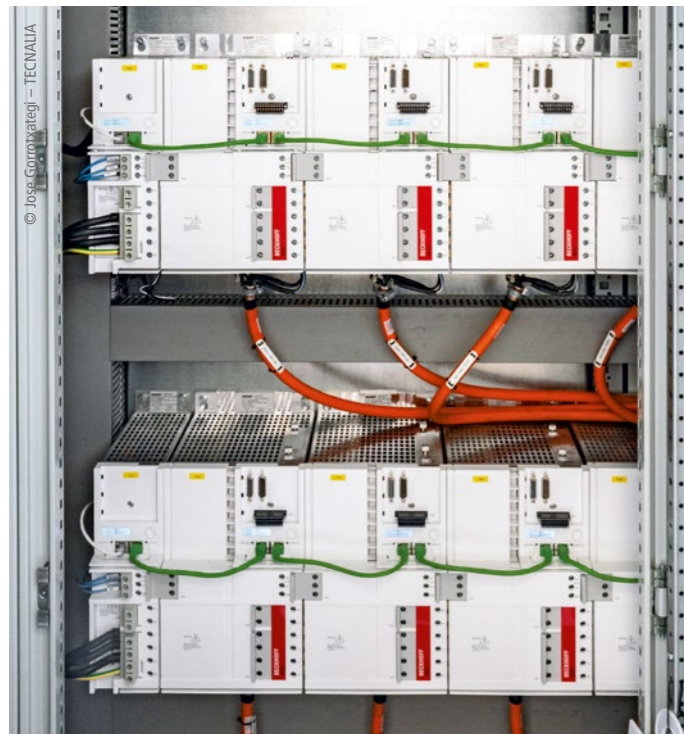
Servoverstärker AX5118 regeln die acht Winden-Antriebe des Seilroboters sowie die vier Achsen des Grundträgers.
