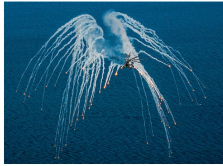
Beide: Neben den passiven Sicherheits- und Schutzsystemen verfügt die CH-53K über eine Reihe aktiver elektronischer Gegenmaßnahmen, inkl. eines modernen Direct-Infrared-Countermeasure-Systems (DIRCM).
