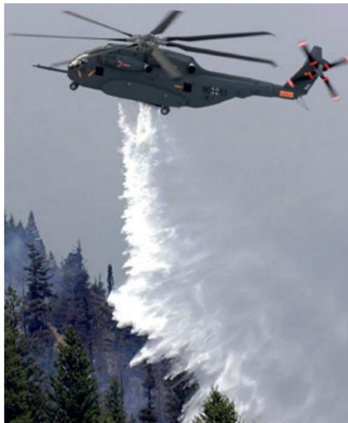
Rechts: Sikorsky CH-53K: Brandbekämpfung aus der Luft mit bis zu 12.000 Litern in internem oder externem Feuerlöschbehälter zur Anwendung in unterschiedlichen Einsatzszenarien.
