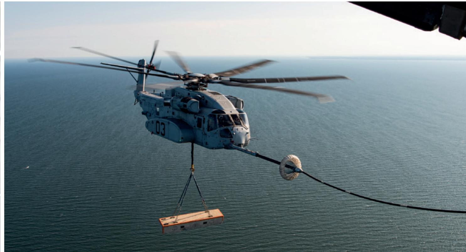
**Oben:** USMC Sikorsky CH-53K mit einer 12 t Außenlast während der Luftbetankung mit dem Tankflugzeug KC-130J.
