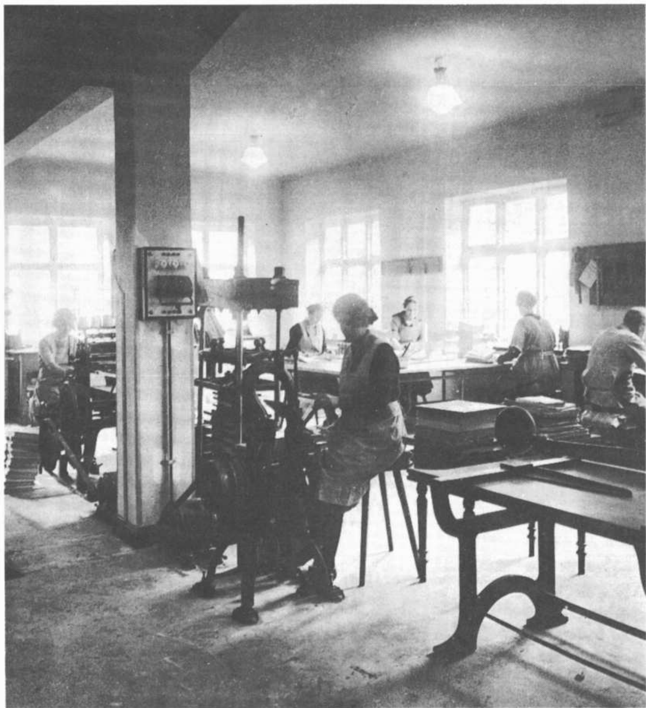
Buchbinderei: „Von der einfachsten Broschüre bis zum stärksten Buch, alles kann gedruckt werden.“ Auch hier arbeiten vorwiegend Frauen. Der Vorgang des Buchbindens ist in fast allen Schritten erkennbar: hinten links werden die Druckbögen gefalzt, hinten rechts sortieren drei Frauen gefalzte Bögen; in der Mitte links näht eine Frau mit der Fadenheftmaschine; im Vordergrund versieht eine Kollegin die genähten Bögen mit Einbänden.
