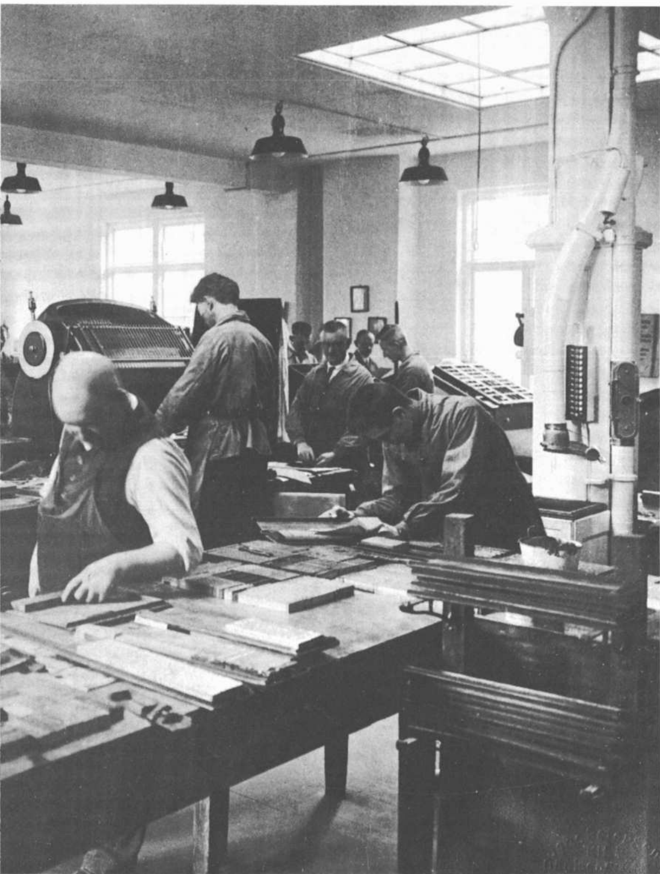
sehen. Im Vordergrund montiert ein Metteur Kolumnen. Metteurs, qualifizierte Setzer mit Berufserfahrung, verdienen etwas mehr als die Setzer. Hinter dem Metteur ist eine Presse erkennbar, die Probeabdrücke für Korrekturen liefert.
